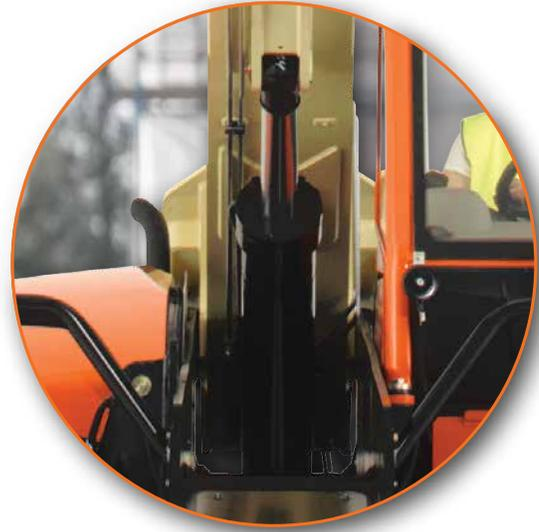
Menos mantenimiento y menos puntos para posibles fugas hidráulicas, debido a que tienen un solo cilindro de elevación de compensación.
