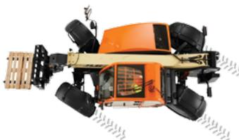
Dirección en cangrejo para el movimiento lateral y posicionamiento exacto antes de la elevación.
